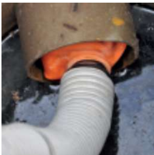
La tubazione da testare verrà automaticamente sigillata in modo ermetico non appena passa il fumo
